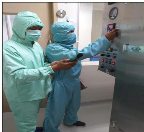
**Gambar 2. Pengukuran Kebisingan menggunakan *Sound Level Meter***
